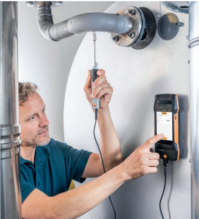
A testo 400 mérőműszerrel egyszerre akár 8 szonda is használható (4 Bluetooth-os és 4 kábeles)
